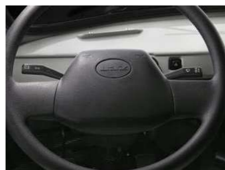
«Мягкое» рулевое колесо. Многофункциональные подрулевые переключатели
