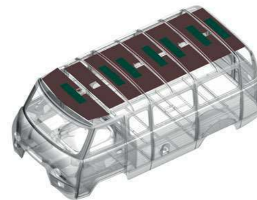
Иглопробивной материал обивки крыши
