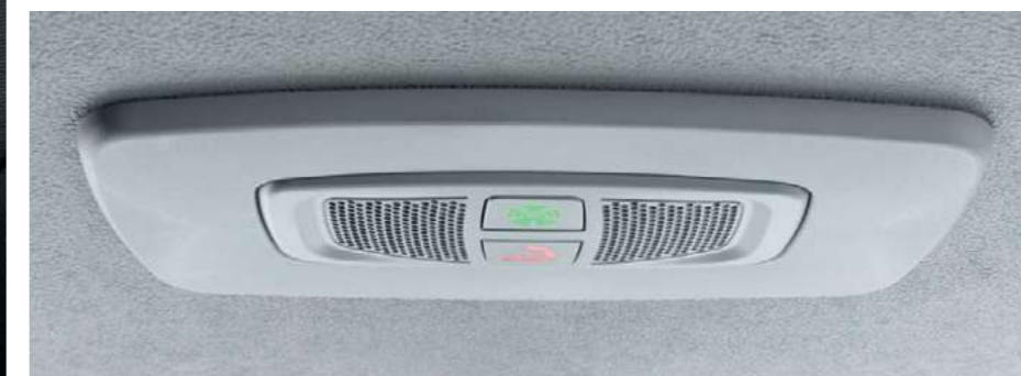
Терминал системы «ЭРА-ГЛОНАСС»
