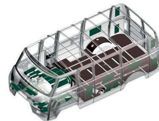
Пакет вибро- и шумоизоляции по всему кузову и специальные подушки крепления кузова
