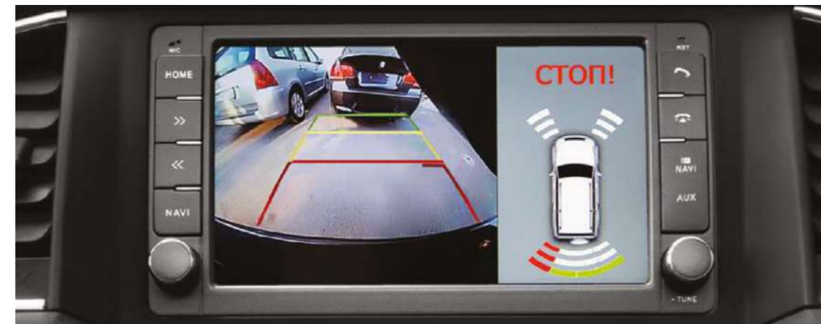
При движении задним ходом на цветной экран выводится изображение с камеры заднего вида с направляющими парковочными линиями и работа задних и передних датчиков парковки
